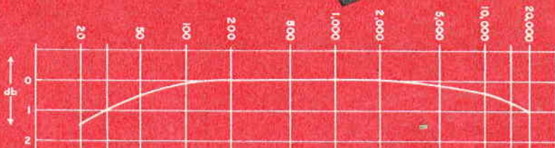
Fig. 1 - Nel grafico riprodotto accanto è possibile conoscere le attenuazioni in decibel in corrispondenza alle varie frequenze acustiche. Come si nota, l'attenuazione per il nostro preamplificatore è mantenuta entro la variazione di 1 decibel per le frequenze comprese fra i 25 e i 25.000 Hertz.
