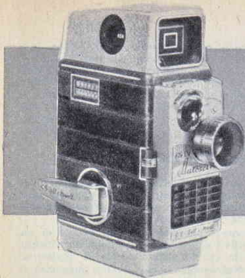
Fig. 1 - In questo tipo di cinepresa, sotto l'obiettivo, è posta la cellula che regola automaticamente l'apertura del diaframma conformemente alla quantità di luce esistente al momento della ripresa per cui all'operatore è riservata la sola operazione di premere un bottone. La cinepresa riprodotta in figura, di tipo completamente automatico, viene costruita dalla Bell and Howell.
